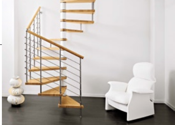
Albini&Fontanot - collezione Reflex Nuovo e completo sistema di scale, con gradini in massello di faggio naturale o in frassino, da 42 mm di spessore, supporti in acciaio e spessori in policarbonato trasparente che consentono la regolazione in altezza. Altamente personalizzabile, Reflex nella foto è proposta con ringhiera Lux (corrimano in legno massello, colonnine a sezione circolare con diametro 27 mm, in acciaio inox con finitura lucida, collegate mediante tondini longitudinali in acciaio inox).
